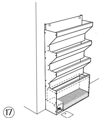
Constituer un hydrodrain dans le fond du liner (gravier ou polystyrène).
